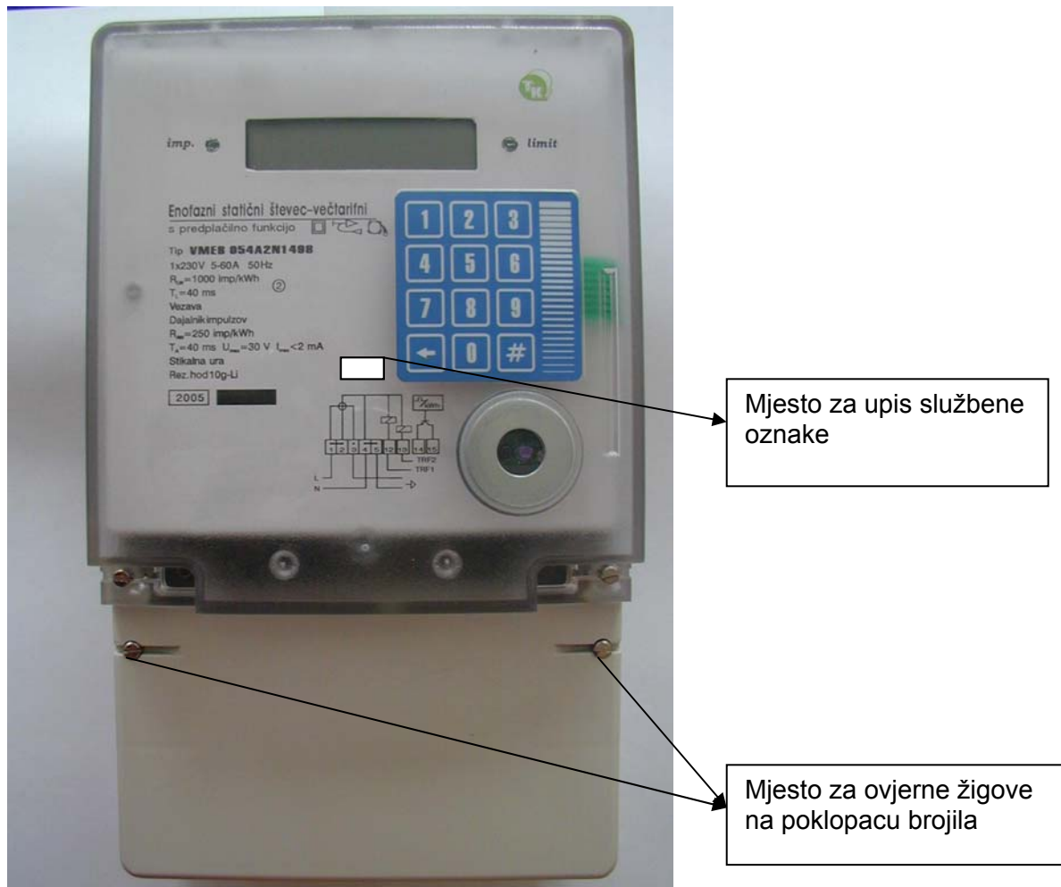
Slika 1: Vanjski izgled brojila s mjestima za plombiranje poklopca priključnih spojnica i mjestom za oznaku odobrenja tipa mjerila
